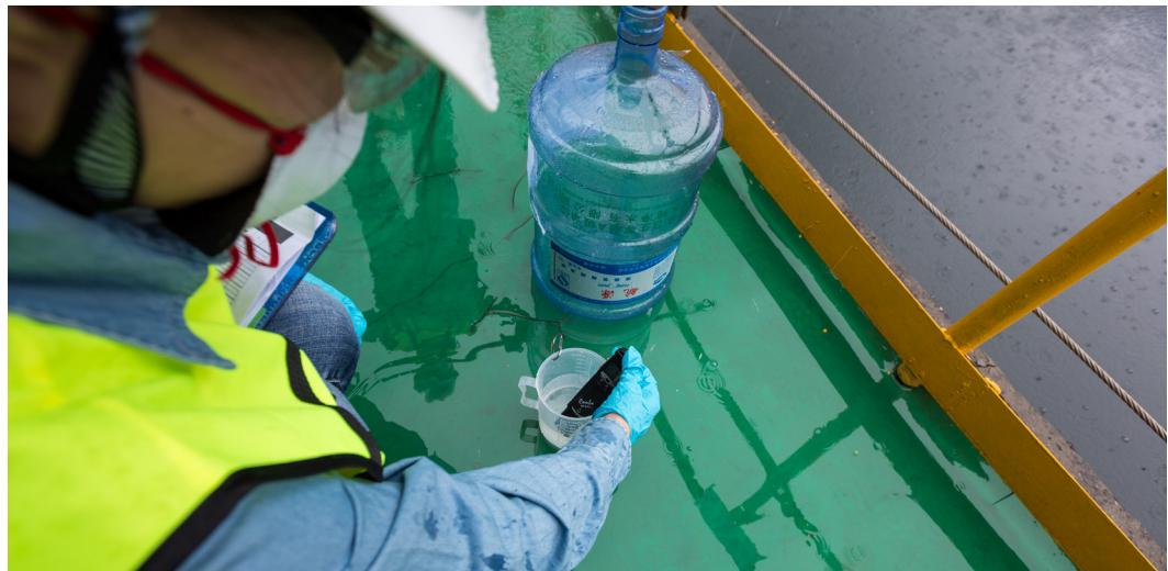
第三方审核员正在中国昆山的一家印制电路板工厂进行废水检测。
